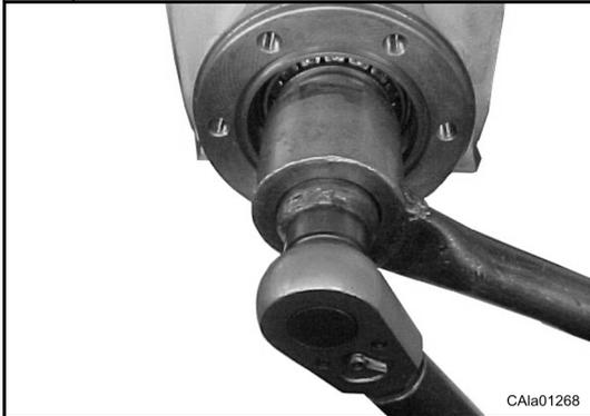
Inserire la rondella fermo ghiera (9) ed avvitare una nuova ghiera di serraggio (10) sul codolo del pignone.
