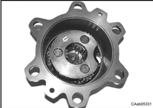
Posizionare il treno portasatelliti (4) su di un piano e verificare le condizioni di usura dei componenti interni.
