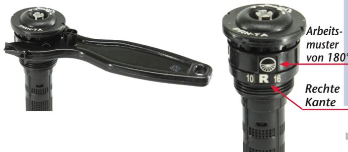
Die einmalige Einstellungsmethode ermöglicht das Voreinstellen des Sektors mit der Hand oder dem Werkzeug vor der Installation der Düse. Mit visuellen Anzeigen kann der Benutzer das Sektormuster auf den gewünschten Sektor von 45 bis 270° einstellen. Der Einstellung kann mit der Hand oder dem mitgelieferten Werkzeug eingestellt werden. Das Werkzeug kann separat unter der Bestellnummer PRNTOOL bestellt werden.
