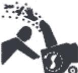
**RAPPELEZ-VOUS :** l'espace existant entre la périphérie des aubes et du rotor et les parois internes du carter est très réduit. L'opérateur de la souffleuse est certain de se blesser s'il place sa main sur le trajet des aubes ou du rotor afin de déboucher un orifice engorgé, sauf s'il arrête au préalable le moteur.
