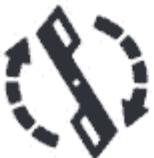
**RAPPELEZ-VOUS** : l'espace existant entre les extrémités de la lame et les parois internes du carter est très réduit. L'opérateur de la tondeuse est certain de se blesser s'il place sa main sur le trajet de la lame pour déboucher un orifice d'expulsion engorgé ou pour modifier la hauteur de coupe, sauf s'il arrête au préalable le moteur.
