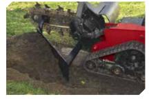
BACKFILL BLADE Easily fill in any trench
