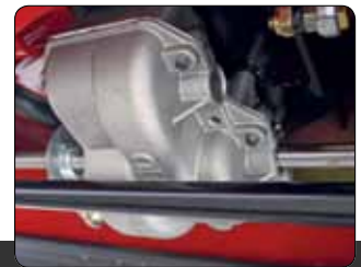
Stufenlos verstellbares Dreiganggetriebe
