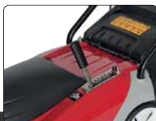
Levier de réglage de la hauteur de coupe en 1 point
