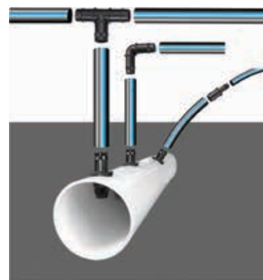
Las cuñas de sujeción aseguran la hermeticidad de la conexión
