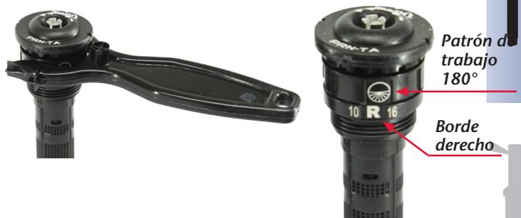
El exclusivo método de ajuste permite preestablecer el arco a mano o con la herramienta antes de instalar la boquilla. Unos indicadores visuales permiten al usuario ajustar rápidamente el arco deseado entre 45° y 270°. La banda de ajuste puede modificarse a mano o con la herramienta incluida. La herramienta puede pedirse por separado como: PRNTOOL
