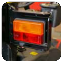
Wegverlichting met remlichten
