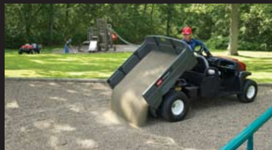
Jämfört med metallflak som bullrar och kan rosta är det här flaket med dubbla väggar i polyetylen mycket tåligt mot dagligt slitage och får aldrig bucklor.
