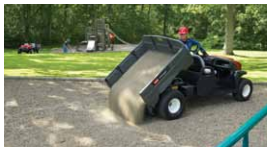
En comparación con las plataformas metálicas, que son ruidosas y susceptibles a la corrosión, estas plataformas de polietileno de doble pared resisten a los abusos diarios y no se abollan jamás.
