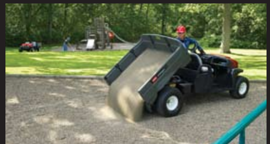
Deze dubbelwandige laadbakken van deukbestendig polyethyleen zijn bestand tegen dagelijks gebruik en in tegenstelling tot metalen laadbakken maken ze geen lawaai en kunnen ze ook niet roesten.
