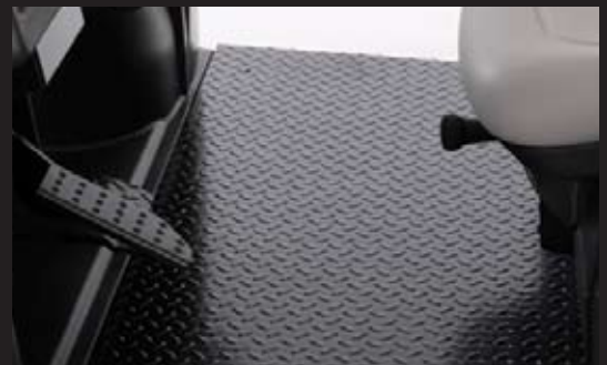
De stalen vloerdelen van traanplaat zien er robuust uit en zijn zeer duurzaam.
