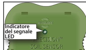
2. Irrigate accuratamente nella posizione del sensore e nell'area verde circostante. *Questa fase è essenziale per stabilire il massimo livello di umidità per la taratura del sensore.*
